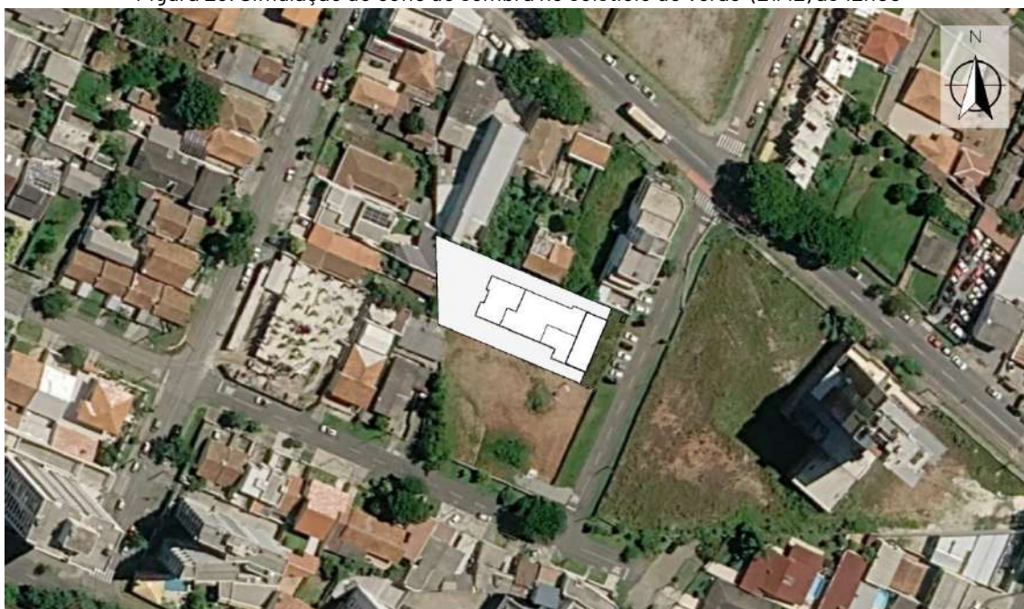
Figura 26. Simulação do cone de sombra no solstício de verão (21/12) às 12h00
