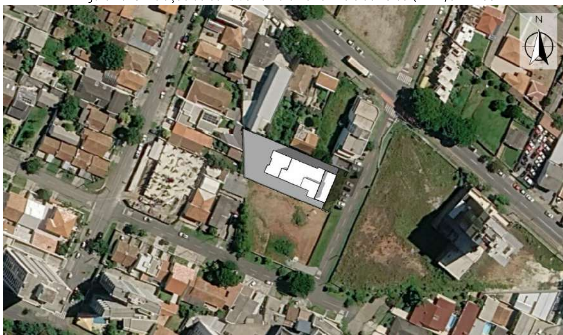
Figura 28. Simulação do cone de sombra no solstício de verão (21/12) às 17h00
