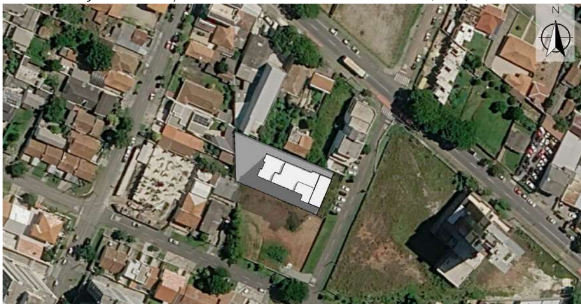
Figura 23. Simulação do cone de sombra no solstício de inverno (21/06) às 9h00
