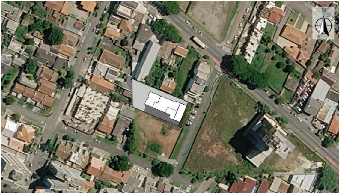
Figura 25. Simulação do cone de sombra no solstício de inverno (21/06) às 12h00
