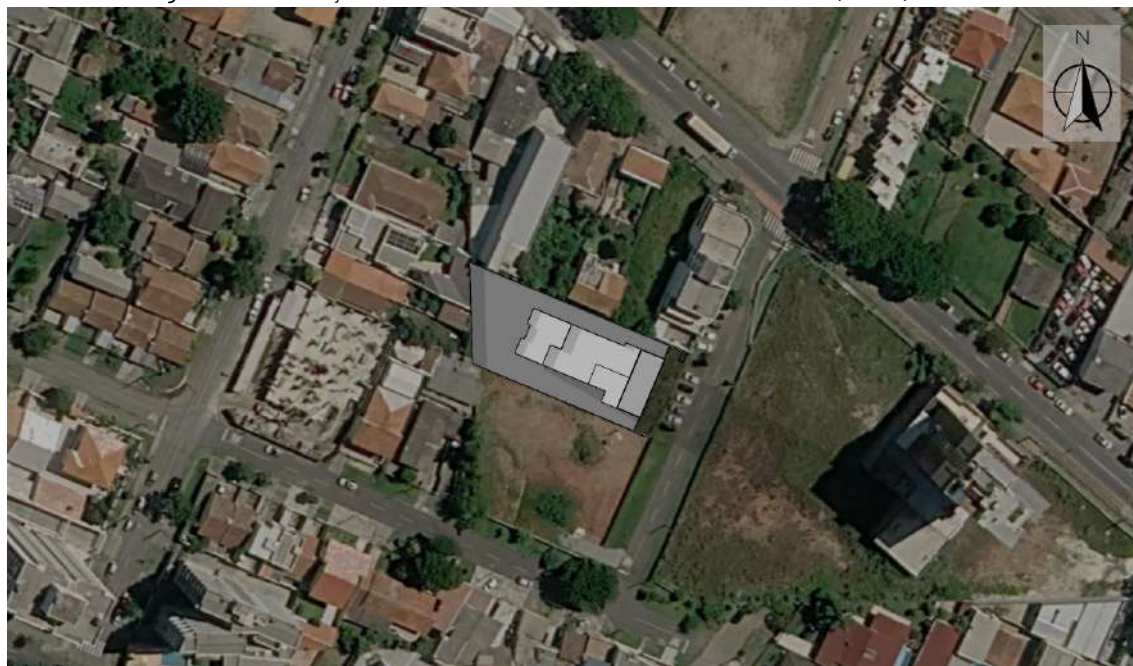
Figura 27. Simulação do cone de sombra no solstício de inverno (21/06) às 17h00
