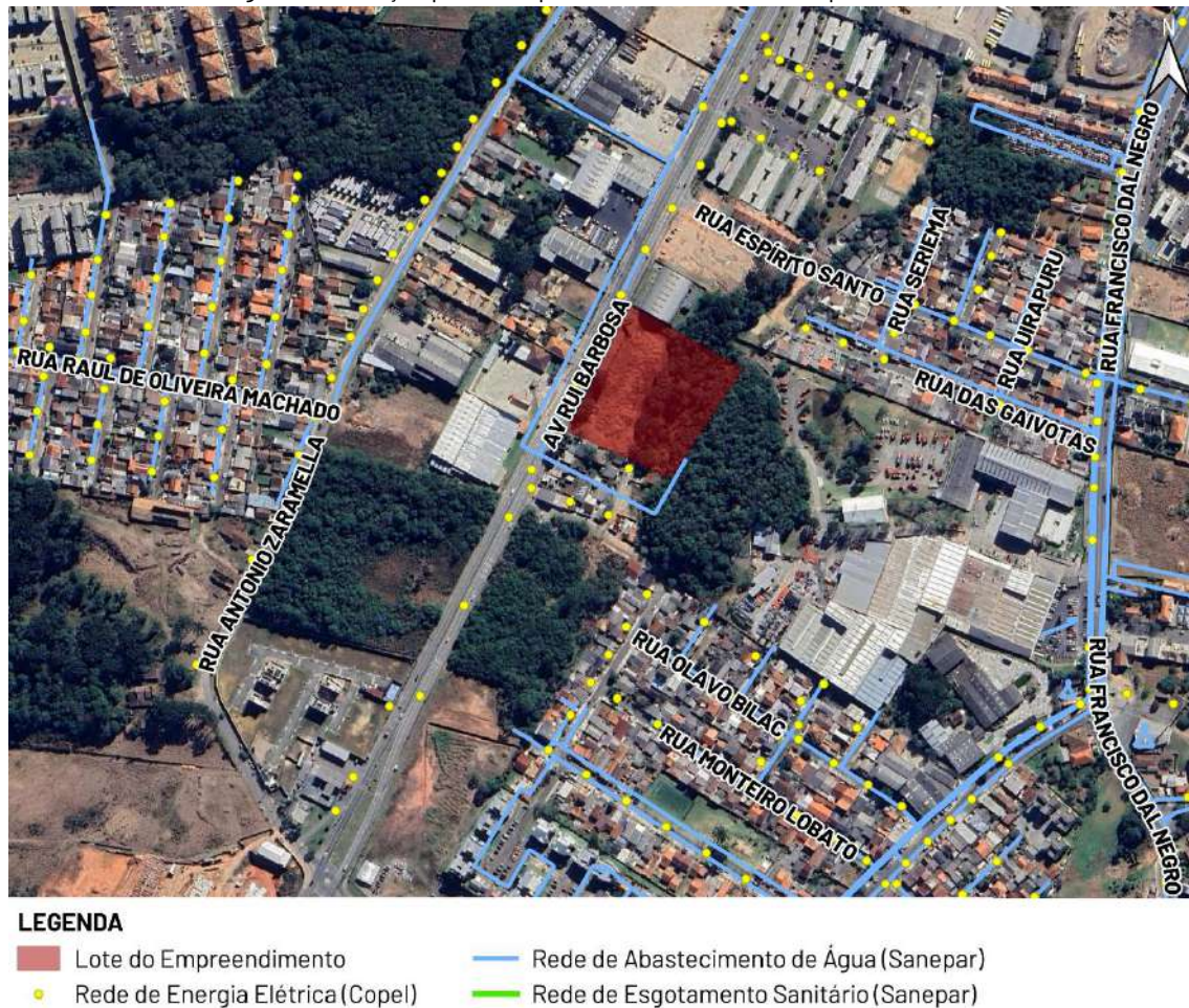
Figura 13. Serviços públicos que atendem ao lote do empreendimento
