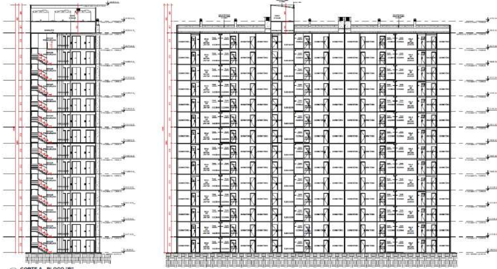
Figura 20. Bloco B: Cortes Transversal e Longitudinal
