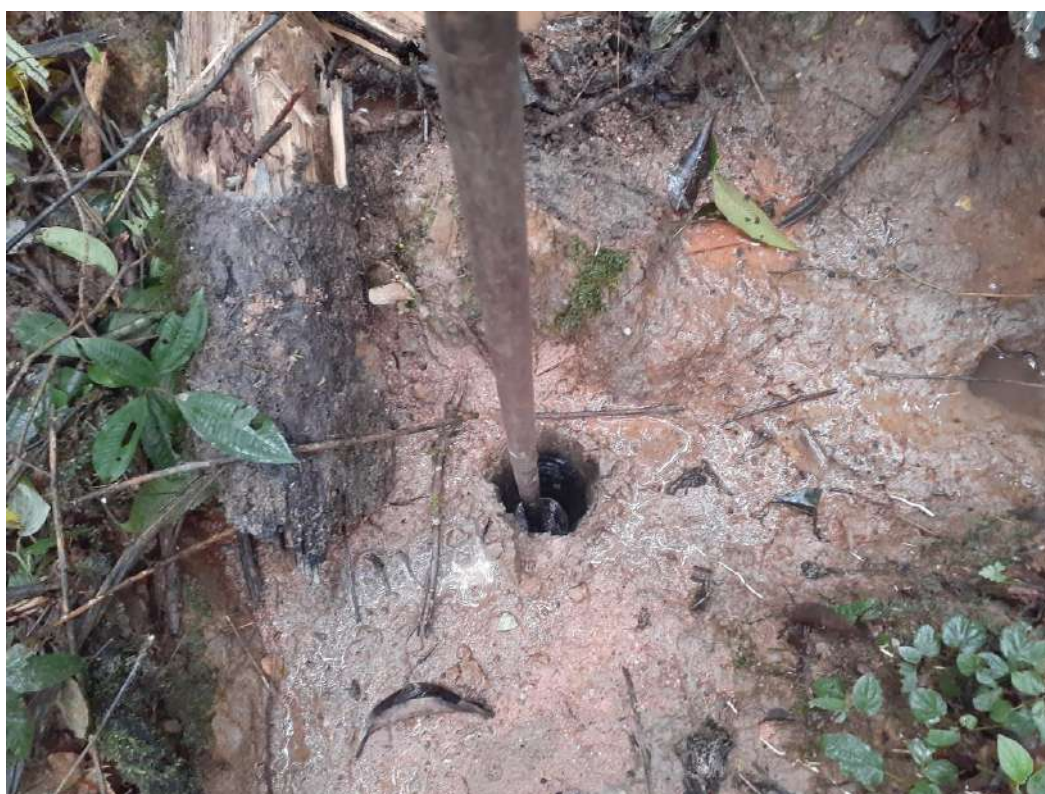
Figura 15 – Sondagem S4, realizada par definição do N. H. e nascente.
