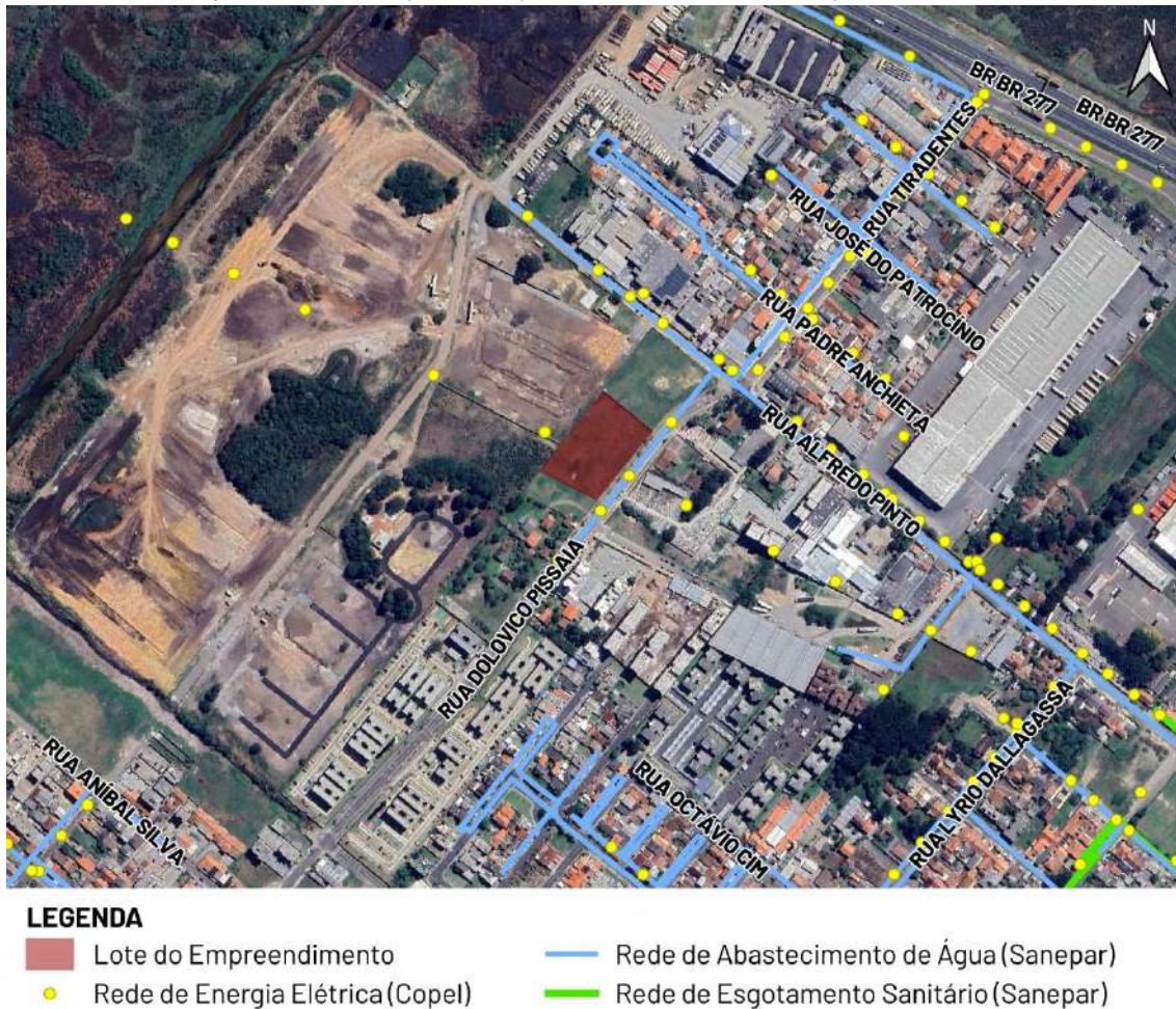
Figura 9. Serviços públicos que atendem ao lote do empreendimento
