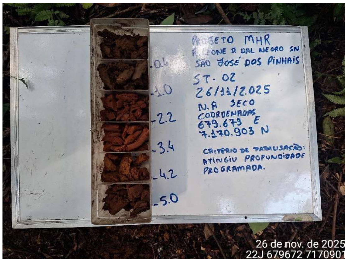
Figura 28: Perfil de solo da sondagem ST-02
