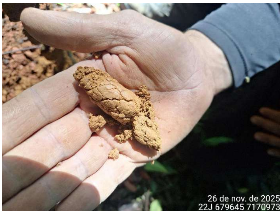
Figura 26: Característica de plasticidade do solo avaliado.
