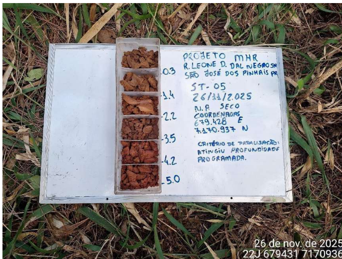
Figura 21: Perfil de solo da sondagem ST-05
