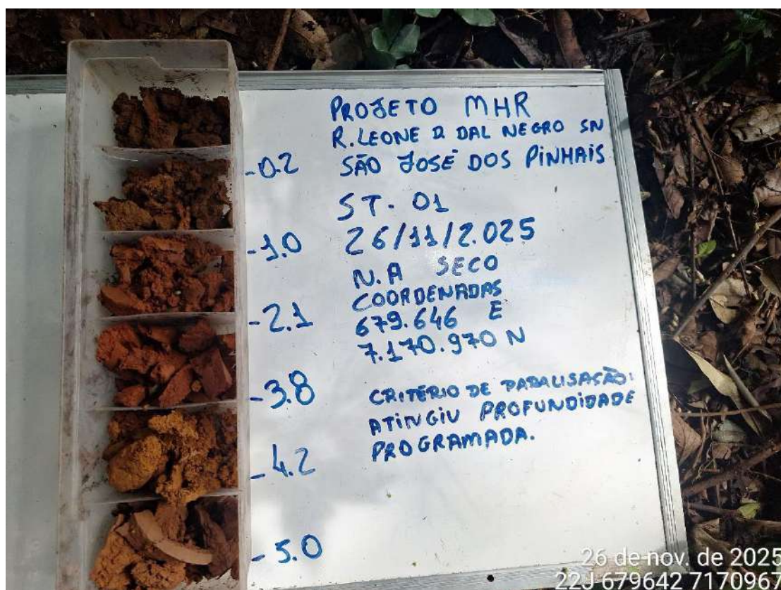
Figura 17: Perfil de solo da sondagem ST-01
