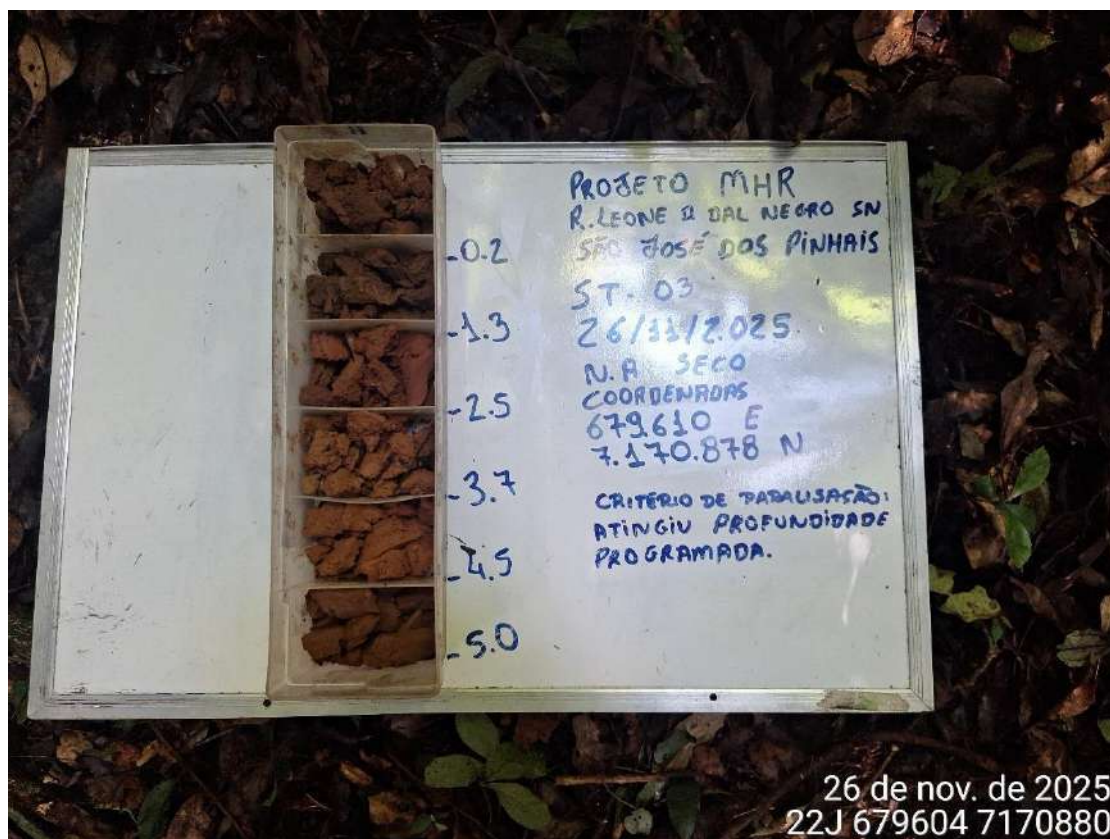
Figura 39: Perfil de solo da sondagem ST-03
