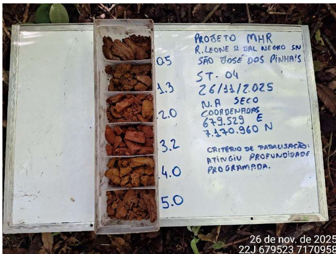
Figura 20: Perfil de solo da sondagem ST-04
