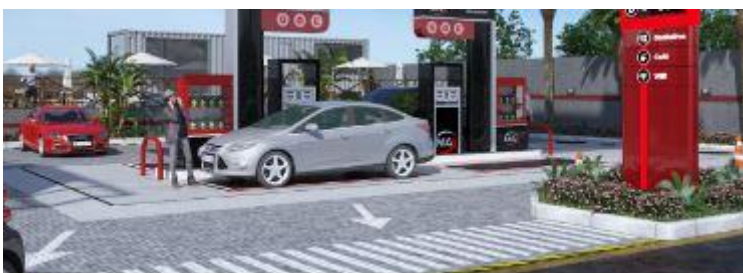
Sinalização horizontal: Modelo de pintura no piso (faixas e setas) nos acessos
