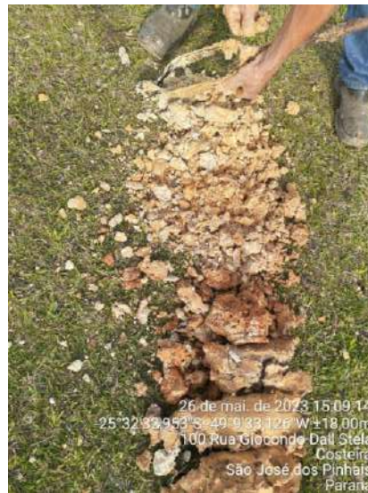
Figura 23 – Solo argiloso cinza claro, passando a solo residual rosa-avermelhado argiloso e argila-arenosa rosa-acinzentada (S1a)
