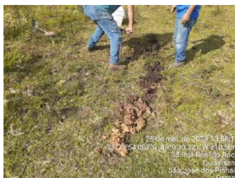
Figura 26 – Solo silto-argiloso marrom, passando a argila cinza-esbranquiçada com fragmentos de quartzo e intercalação entre argila e silte-arenoso rosa-avermelhado (S2a)
