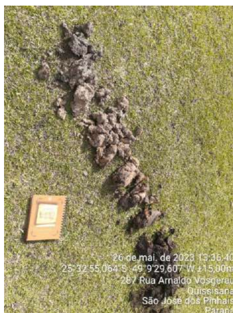
Figura 24 – Solo silto-argiloso cinza escuro, passando a argila-cinza-rosada e silto-argiloso-arenoso cinza-esbranquiçado oxidado (S1b)
