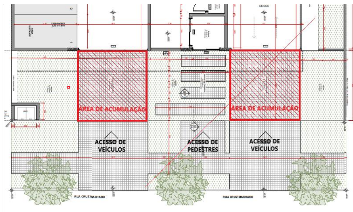
Figura 28: Detalhe da área de acumulação e dos acessos de veículos separado dos pedestres do Condomínio Sintropia Sky Garden.
