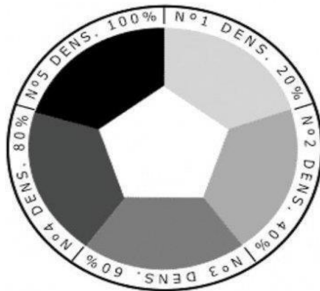
Figura 19 - Escala de Ringelmann
