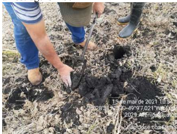
Figura: 31 - Sondagens a trado para amostragens – S6
