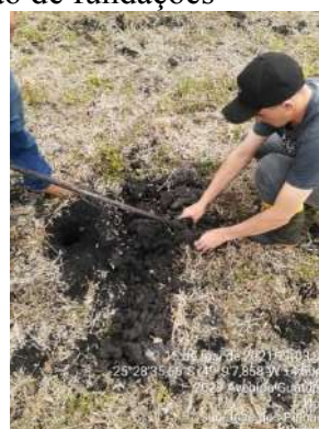
Figura 25 – Argila-turfosa que inspira cuidados especiais com relação à construção de fundações
