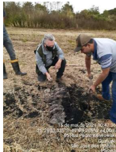
Figura 14 – S5 argila-turfosa passando a argila siltosa marrom a cinza
