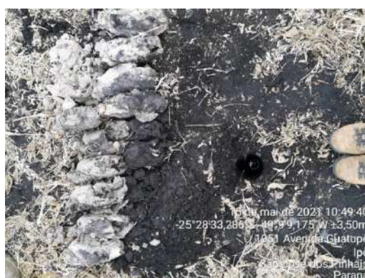
Figura 15 – S6 argila cinza plástica
