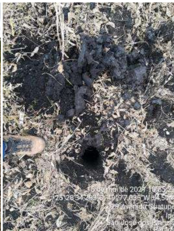
Figura 8 – Sedimentos argilo-turfosos passando a argilo-silto-arenosos
