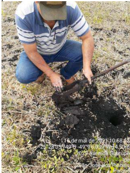
Figura 18 – S9 argila turfosa preta a cinza gradando para argila cinza plástica
