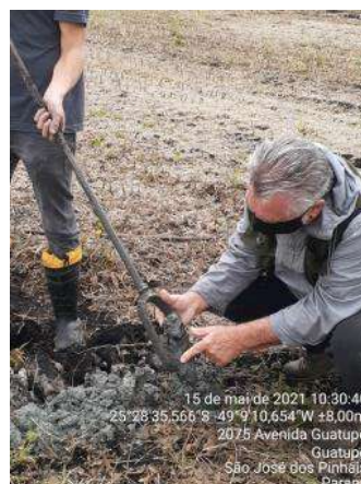
Figura 15 – S6 argila cinza plástica
