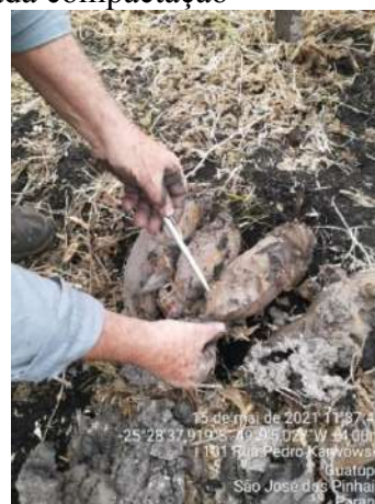
Figura 25 – Argila-turfosa que inspira cuidados especiais com relação à construção de fundações
