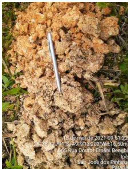
Figura 6 - Solos argilosos vermelhos residuais, passando para argilas plásticas vermelhas com níveis de argila branca.
