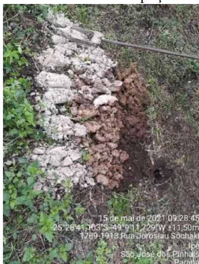
Figura 12 – S3 Solo orgânico areno-argiloso cinza a preto passando a argila-arenosa esverdeada
