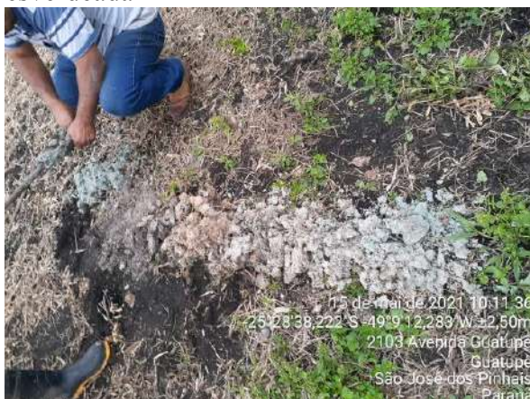
Figura 14 – S5 argila-turfosa passando a argila siltosa marrom a cinza
