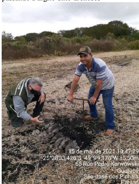
Figura 8 – Sedimentos argilo-turfosos passando a argilo-silto-arenosos
