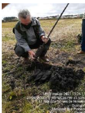
Figura 24 – Solo argilo-turfoso bastante frágil
