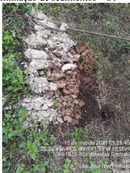
Figura: 33 - Sondagens a trado para determinação de sedimentos – S1
