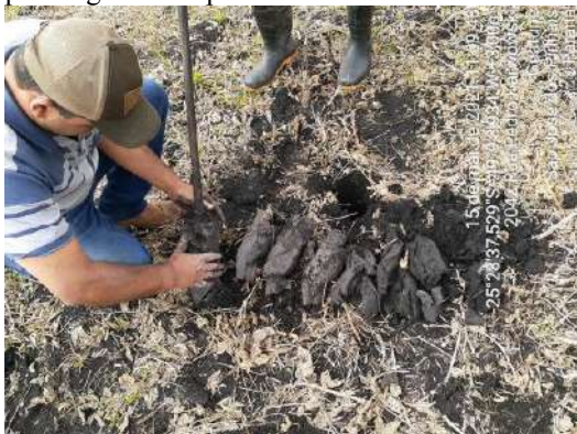
Figura 18 – S9 argila turfosa preta a cinza gradando para argila cinza plástica
