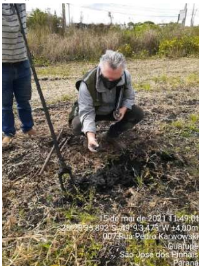
Figura 20 – S11 argila-turfosa passando a argila cinza
