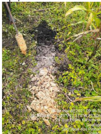
Figura 13 – S4 argila-arenosa cinza esverdeada
