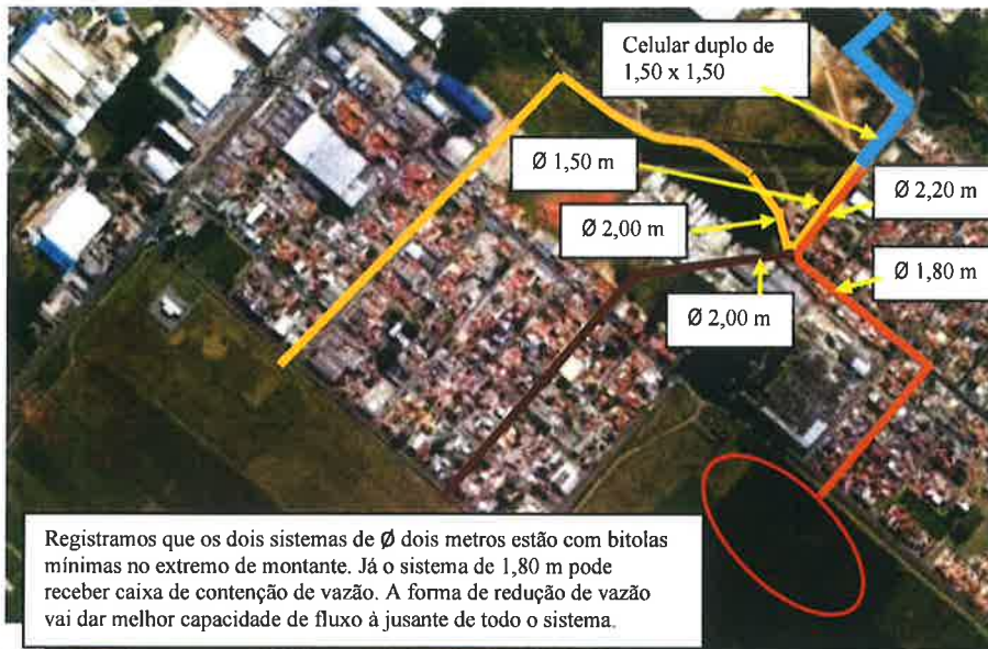
Sistema de águas pluviais oriundo da área do aeroporto. O sistema já existente está em seu limite último.
