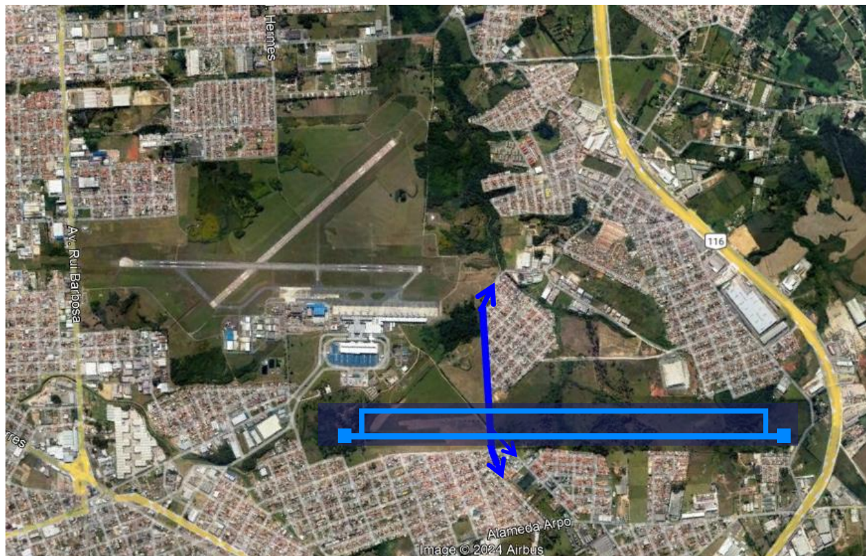
Imagem 5.3: Desvio configurando passagem em desnível sob a nova PPD (ponte).
