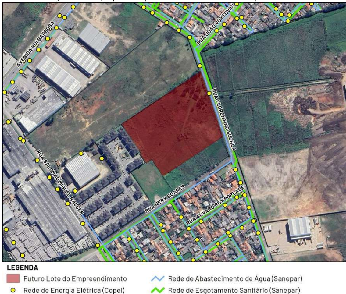
Figura 14. Serviços públicos que atendem ao futuro lote do empreendimento
