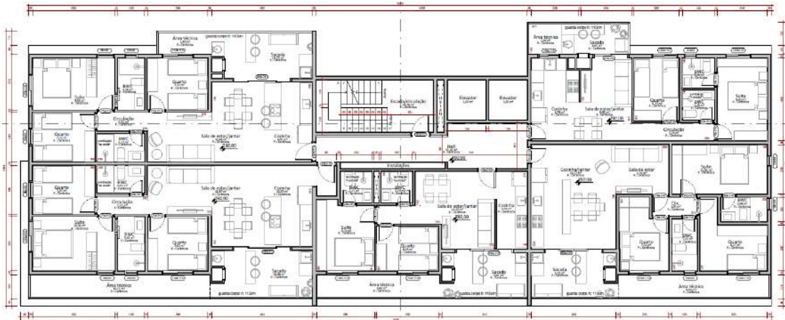
Figura 18. Planta do 2º ao 5º Pavimento
