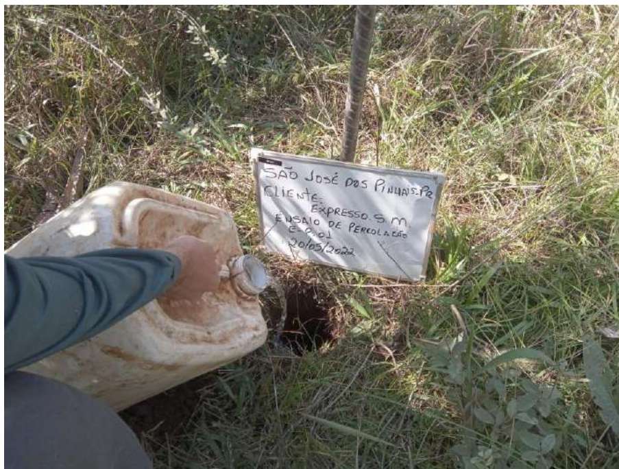
Fotografia 13 - Ensaio de Permeabilidade Ponto SP1
