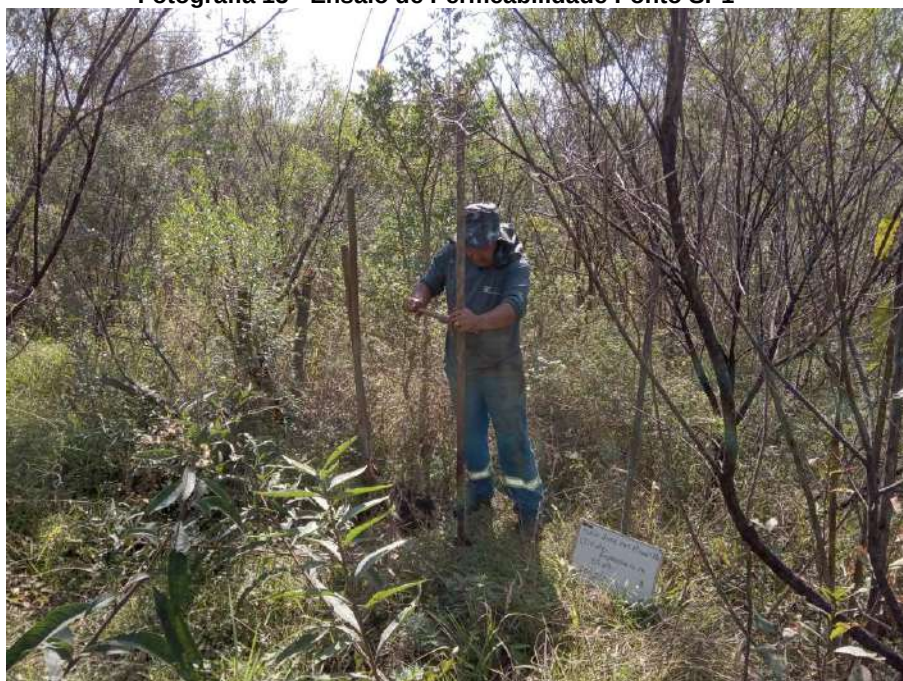
Fotografia 14 - Perfuração para ensaio de Permeabilidade SP 4
