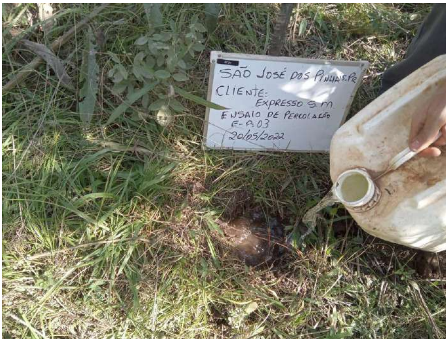
Fotografia 11 - Ensio de Permeabilidade Ponto SP3
