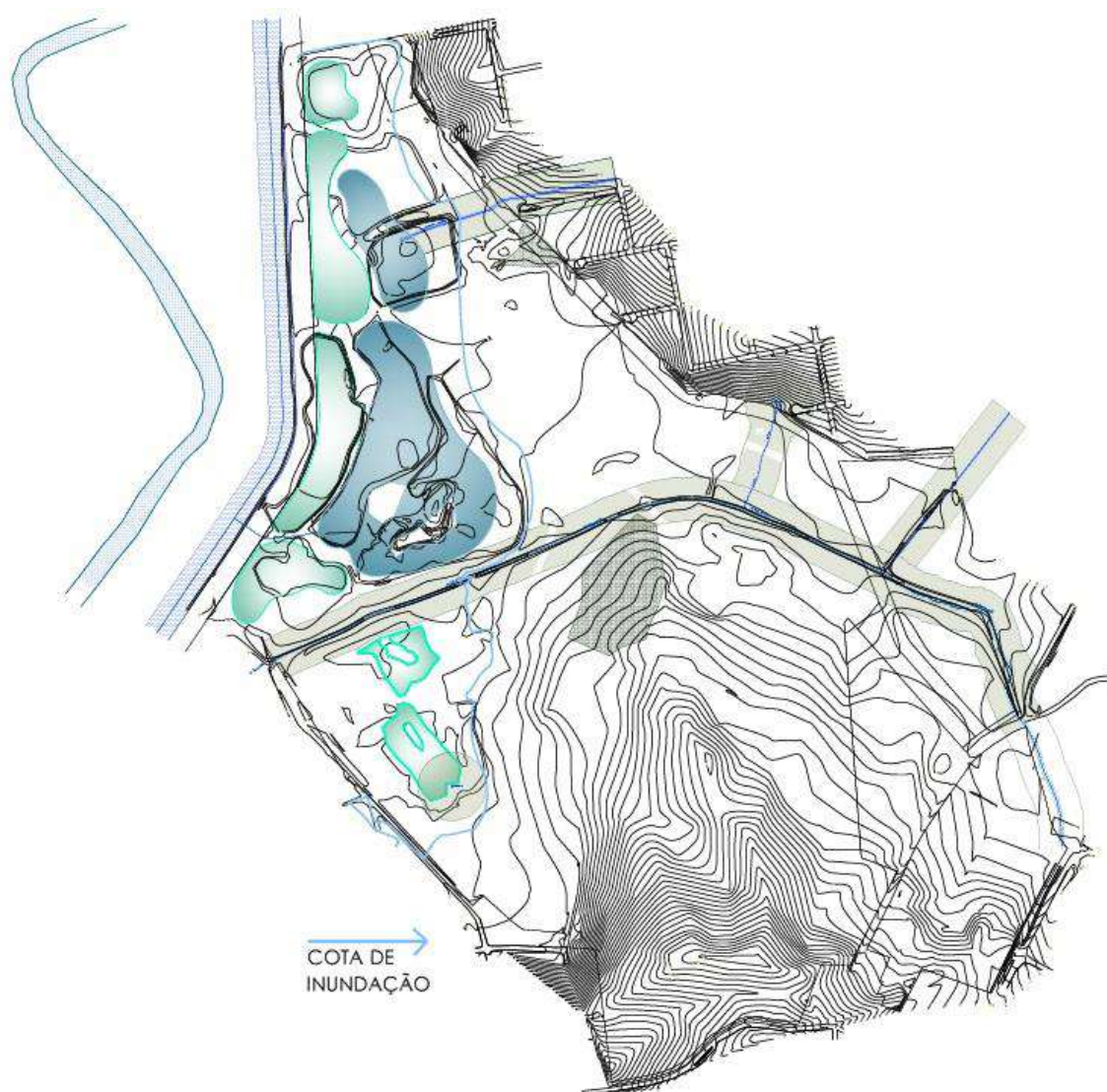
Figura 2.3. Levantamento planialtimétrico do lote, com indicação do atingimento da cota de inundação (azul claro) e limite do lote (polígono preto)
