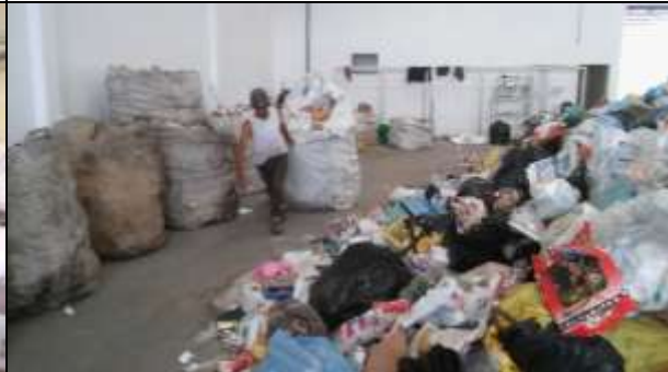
Reciclar - Transporte manual do material, executado sem o equipamento correto.
